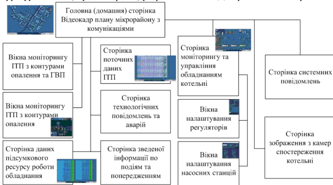
Рисунок 1. Структурна схема автоматизованої системи диспетчеризації тепlopостачання.
